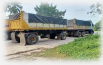
ปิดคลุมท้ายรถบรรทุก
