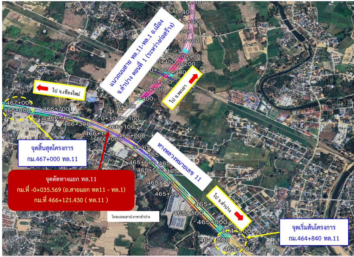
รูปแบบถนน ทล.11 มีถนนหลักเป็นถนนจำนวน 4 ช่องจราจร ถนนคู่ขนานด้านละ 2 ช่องจราจร แบบ 2 ทิศทาง (Two Way) (ความกว้างเขตทาง 70 เมตร)
